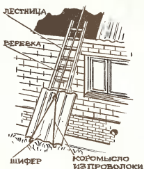
Рис. 14. Подъем шифера на крышу.
